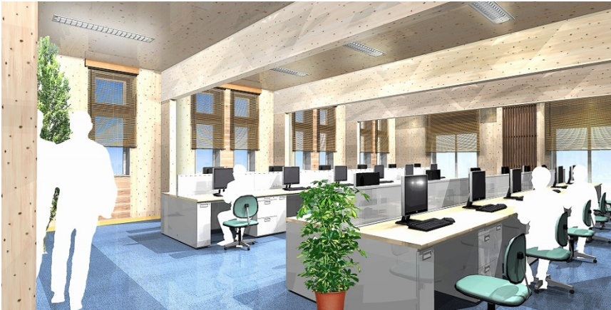
CLTを内装材として使用。接合金物がほとんど見えない工法のためすっきりとした空間を実現
