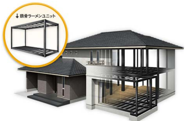
【トヨタホーム独自の鉄骨ラーメン構造】
